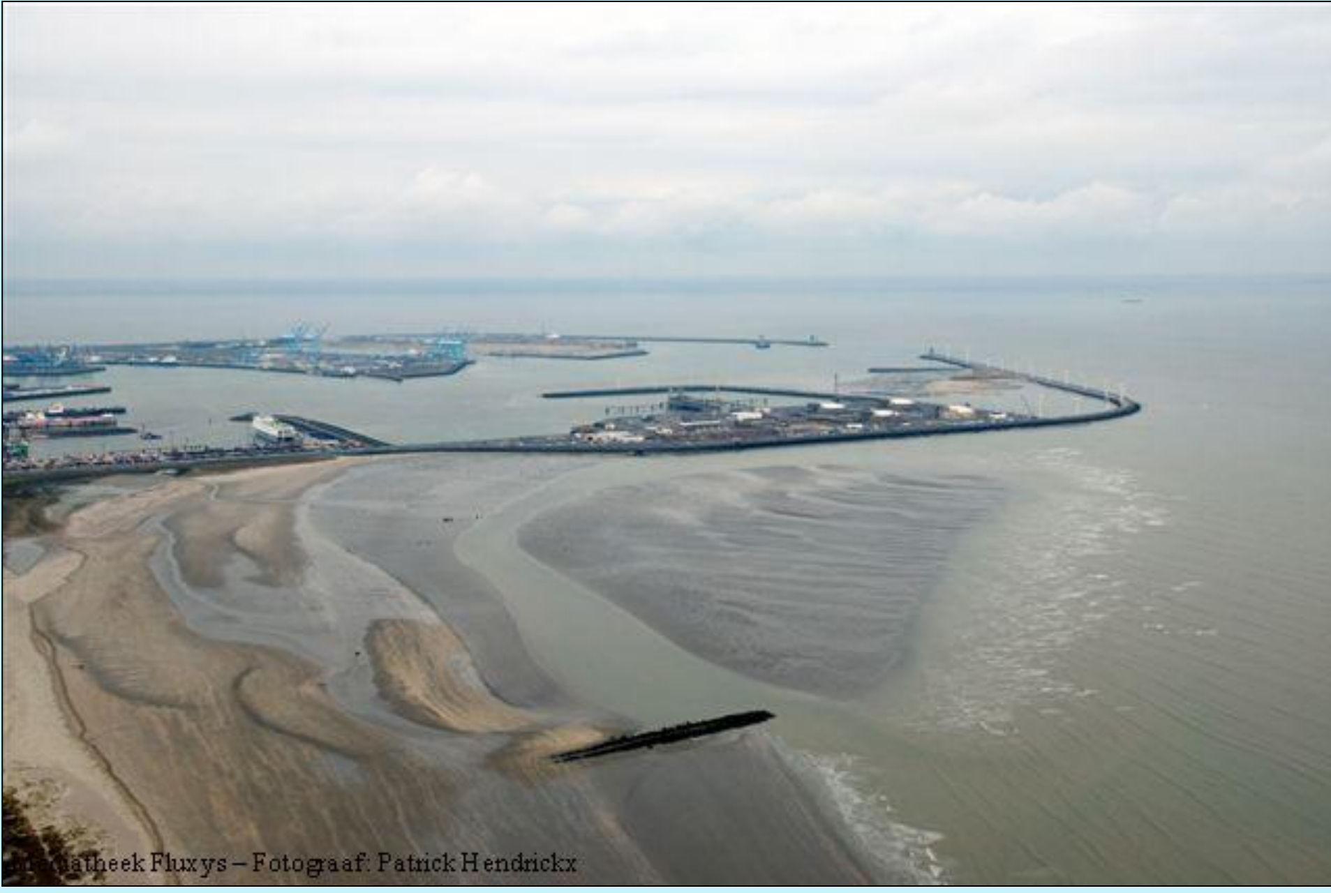
Figuur 1: Luchtfoto van de baai van Knokke-Heist bij laagwater, waarop de zandbank, de geul tussen bank en strand en het toen nog niet opgeruimde strandhoofd 51 duidelijk te zien zijn.,
